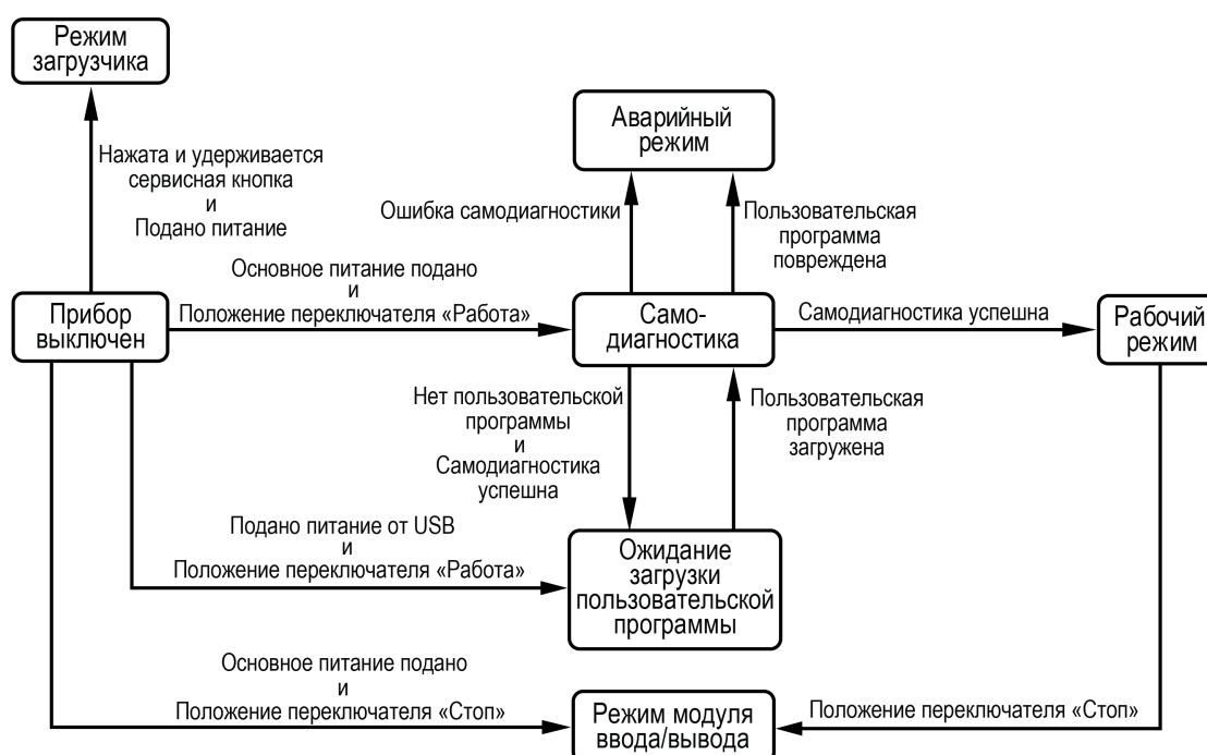
Рисунок 7.5 – Схема переходов между режимами работы
