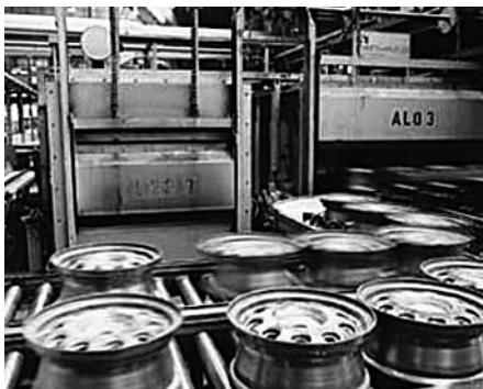
Алюминиевая промышленность: печь отпуска колес
