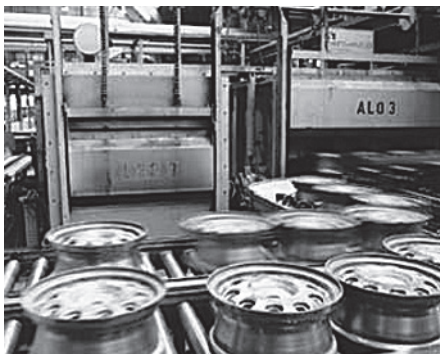
Алюминиевая промышленность: печь отпуска колес
