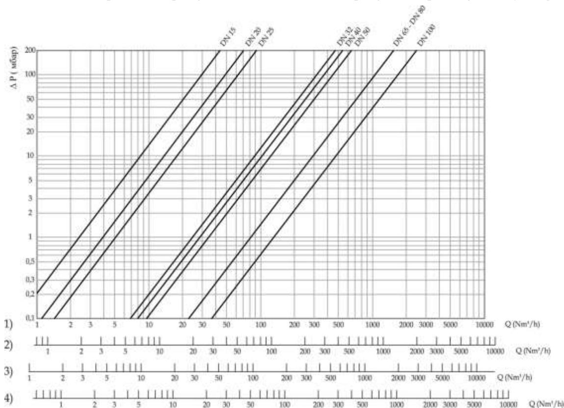
**5.8. Диаграмма пропускной способности регулятора FRG/2MC (с фильтром)**
