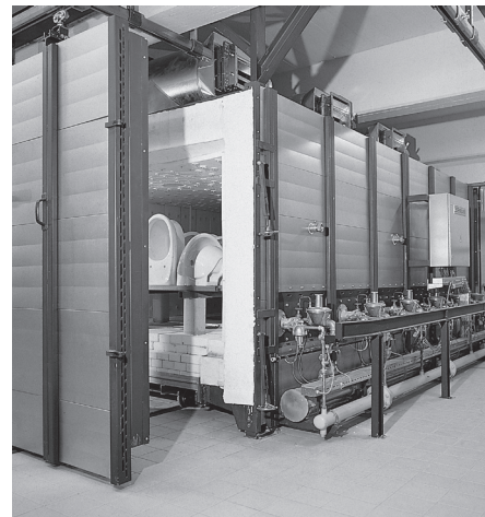
Печь с выкатным подом в керамической промышленности
