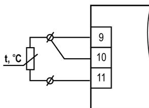
Рисунок 5.4 – Подключение ТС по трехпроводной схеме
