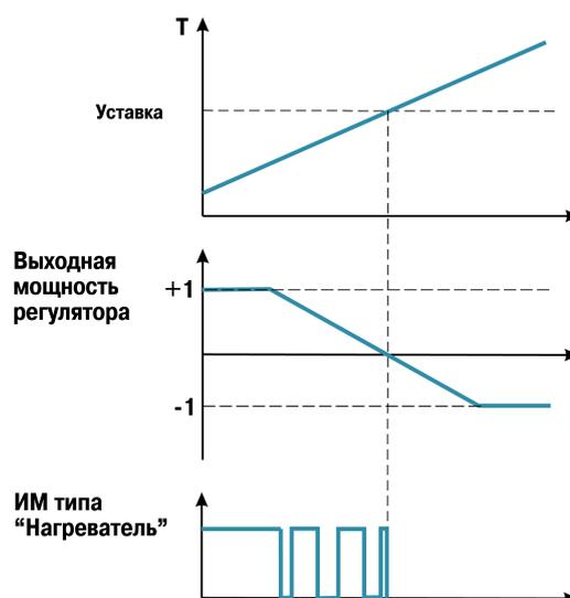
Рисунок 10.9 – Принцип формирования ШИМ-сигнала для «нагревателя»
