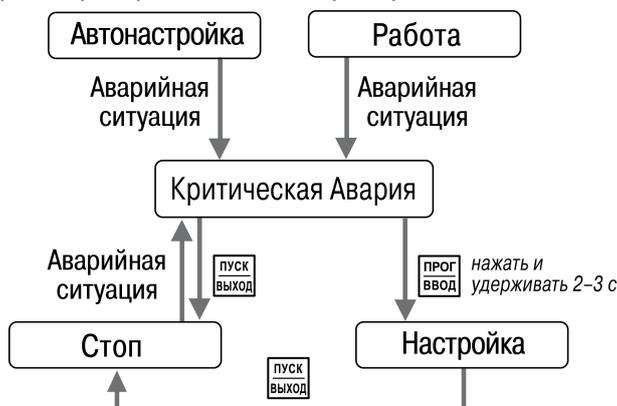
Рисунок 7.11 – Схема переключения режимов при Критической Аварии
