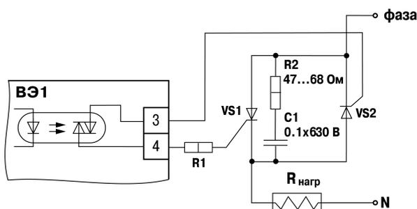
Рисунок 5.10 – Управление двумя тиристорами, подключенными встречно-параллельно
