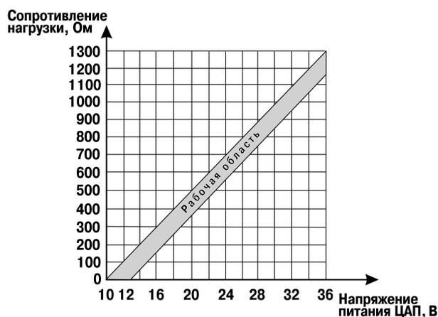
Рисунок 5.12 – Зависимость нагрузки от напряжения питания ЦАП
