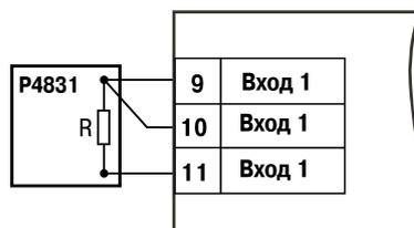
**Рисунок 11.2 – Схема соединения с магазином сопротивлений**
