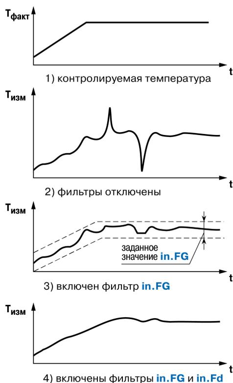
Рисунок 7.1 – Временные диаграммы работы Цифровых фильтров
