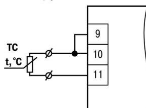
**Рисунок 5.5 – Подключение ТС по двухпроводной схеме**
