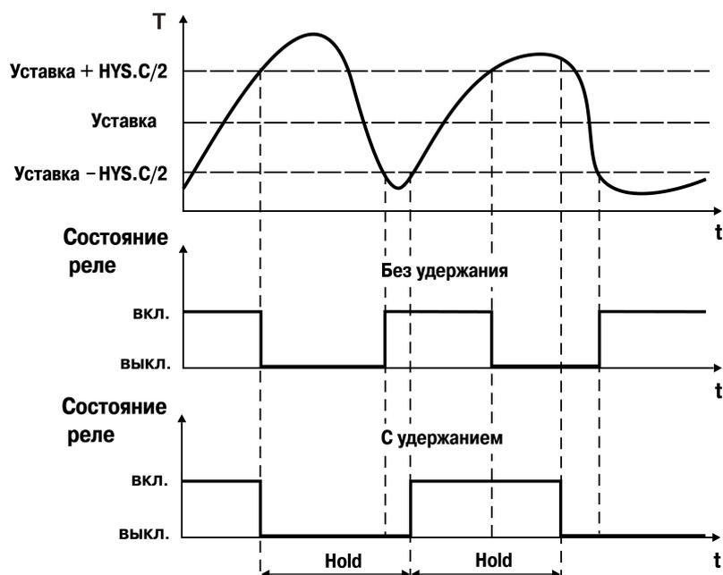
Рисунок 10.16 – Работа регулятора с заданным удержанием
