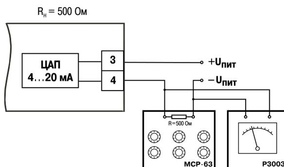
Рисунок 11.5 – Схема подключения к ВЭ типа «И»
