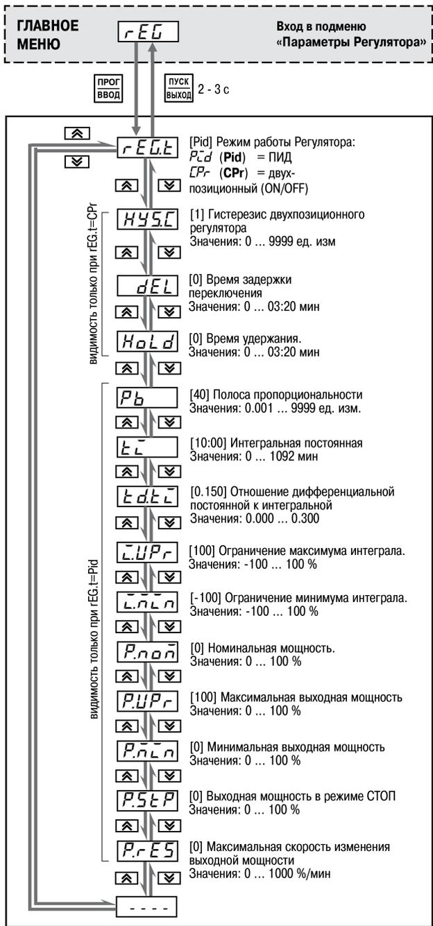
Рисунок 8.3 – Параметры регулятора
