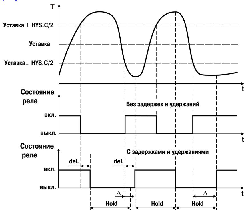
Рисунок 10.17 – Работа регулятора с заданным удержанием
