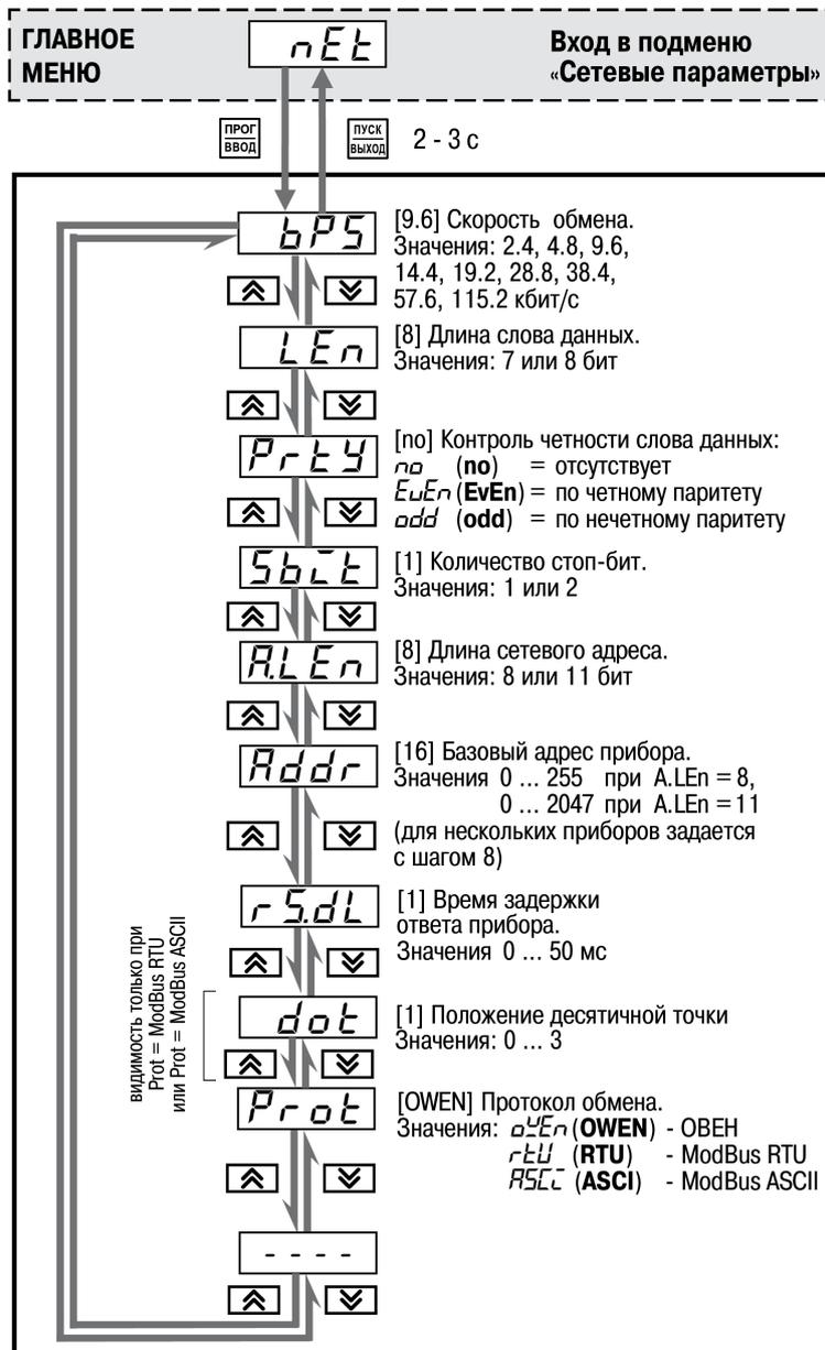
Рисунок 8.9 – Сетевых параметры
