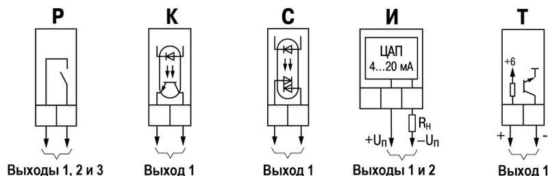
Рисунок 5.7 – Схема подключения к разным типам ВЭ
