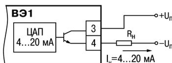
Рисунок 5.11 – Подключение нагрузки к ВЭ типа «И»
