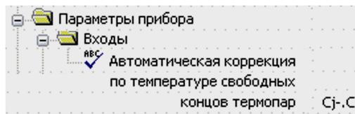
**Рисунок 10.4 – Параметр Автоматическая коррекция показаний прибора по температуре свободных концов термопар (Сj-.С)**
