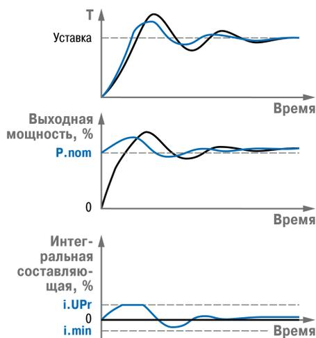
**Рисунок 7.9 – Пример ПИД-регулирования 2**
