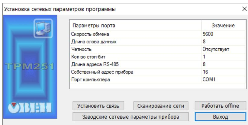
Все приборы ТРМ251 поставляются пользователю с одинаковыми сетевыми настройками. Программа «Конфигуратор ТРМ251» при первом запуске имеет «по умолчанию» те же сетевые настройки. Поэтому при первом подключении прибора ТРМ251 к компьютеру связь должна устанавливаться автоматически. При последующих запусках программа начинает работать с сетевыми настройками, установленными на момент закрытия программы. Если связь по неизвестным причинам установить не удастся, необходимо обратиться к производителю.
