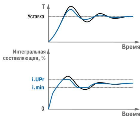
Рисунок 7.8 – Пример ПИД-регулирования
