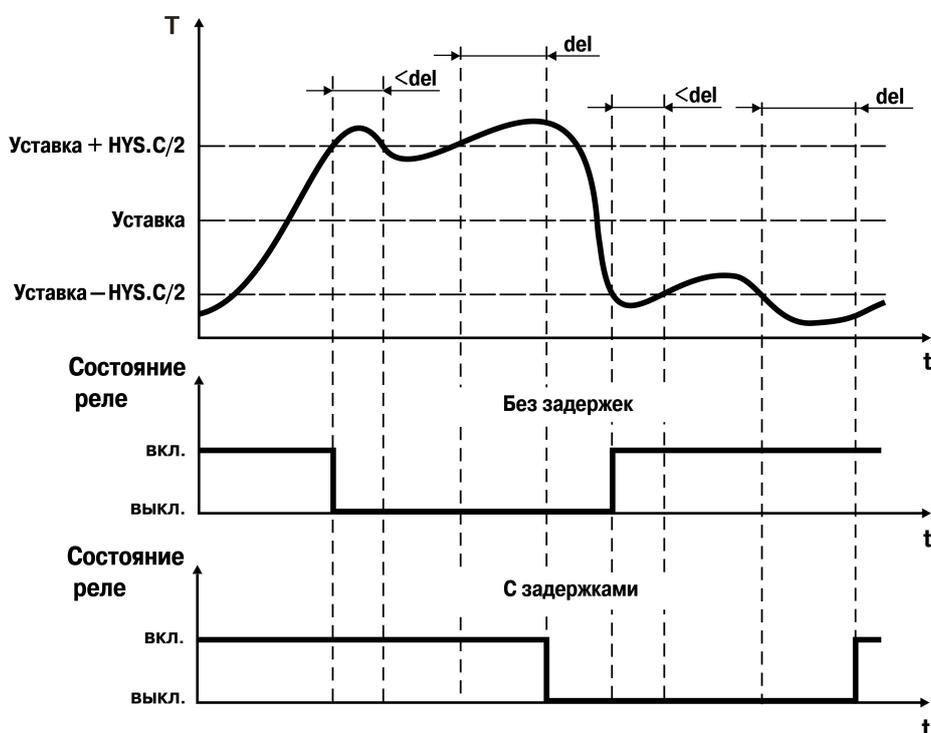
**Рисунок 10.15 – Работа регулятора с заданными задержками**
