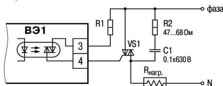
Рисунок 5.9 – Подключение к ВЭ нагрузки типа «С»
