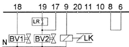
**Управление приводом воздушной заслонки во время работы под действием управляющих сигналов на клемме 17**
