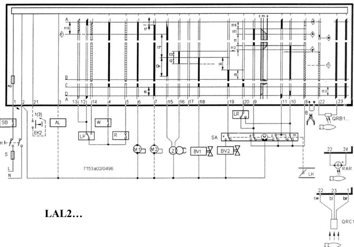
■ Управляющие сигналы от блока управления горелки.
