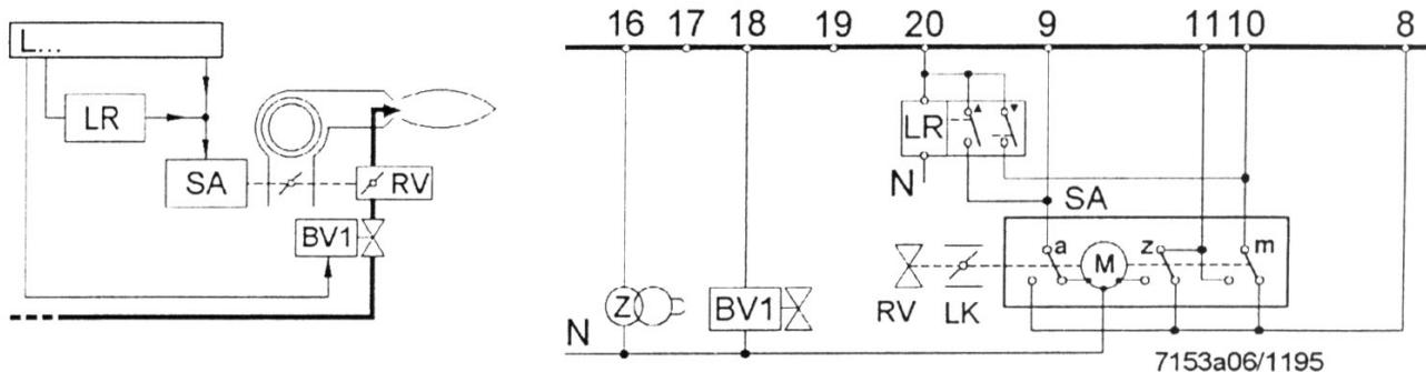
Блок управления нагрузкой с модуляционным контроллером с гальваническими отделенными управляемыми контактами для положений «открыто», «закрыто».
