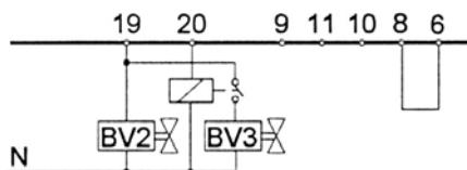
**Управление топливным клапаном через клемму 20**
