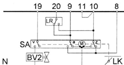
**Подсоединение приводных механизмов без перевода концевого выключателя в положение "закрыто".**
