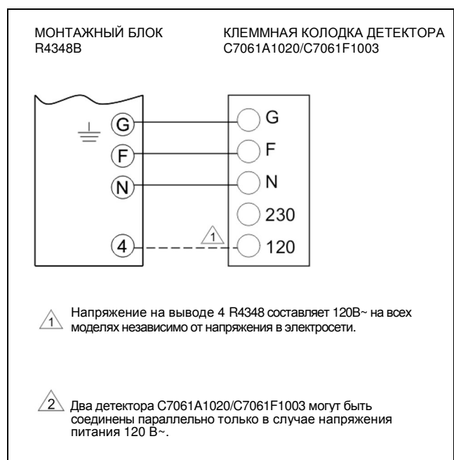
Рис. 10_4. Схема соединений детектора C7061A1020/C7061F1003 с блоком управления системы защиты пламени R4348B со схемой привода затвора датчика.
