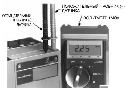
Рис. 22. Измерение сигнала пламени.
