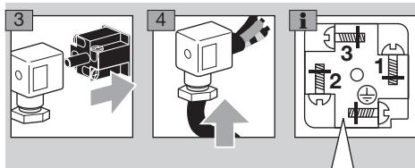
Присоедините разъем по схеме подключения применяемого автомата управления газовой горелкой, автомата контроля пламени или блока управления горелкой, включая защитный заземляющий провод.
