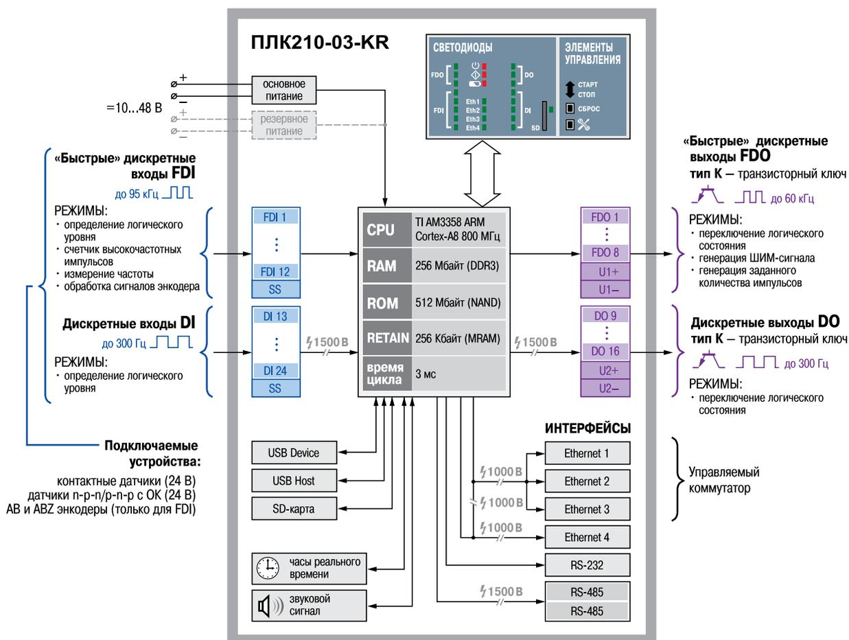
Рисунок 3.4 – Функциональная схема ПЛК210-03-KR
