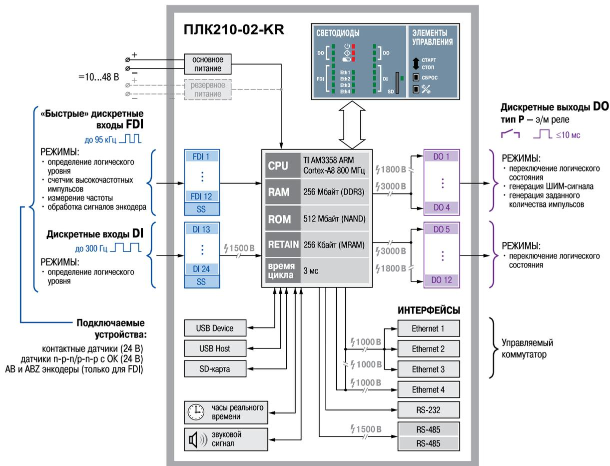
Рисунок 3.3 – Функциональная схема ПЛК210-02-KR
