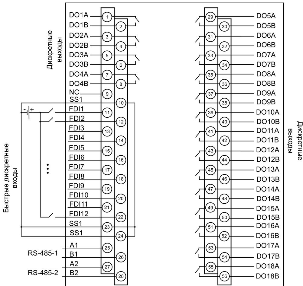
Рисунок 5.2 – Назначение контактов клеммника (модификация 01)
