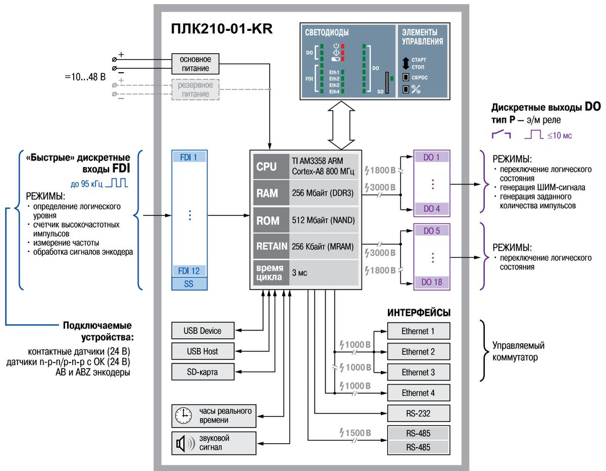
Рисунок 3.2 – Функциональная схема ПЛК210-01-KR
