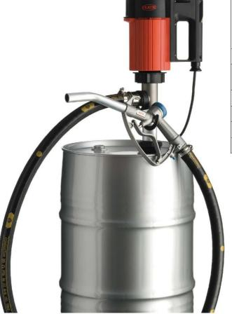
Производительность макс. 220л/мин, напор макс. 12 м.\* При использовании насоса со шлангом и раздаточным пистолетом производительность составляет около 80 л/мин.
