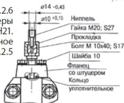
рис. 2.2.7 Размеры для КМЧ Н16 ... Н19. Остальное см. рис. 2.2.1...2.2.3
