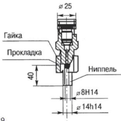
рис. 2.6.5 Размеры для КМЧ НЗЗ. Остальное см. рис. 2.6.1; 2.6.2; 2.6.3
