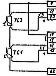
б) Подключение одного термопреобразователя сопротивления одновременно на входы X1 и X3
